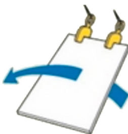
Turning-over of steel plates/ Cambio de cara de láminas de acero
